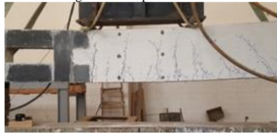
Fig. 8e Crack pattern for BSOC2
